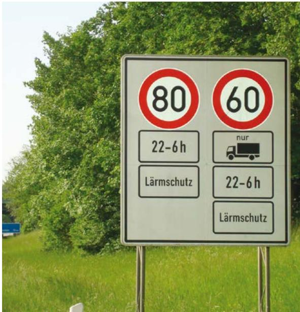
Abbildung 14: Zeit- und fahrzeugabhängige Geschwindigkeitsbeschränkung (Foto Kühne)
