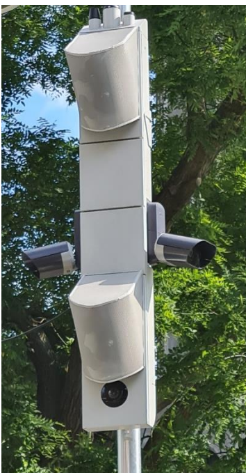
Abb. 2.3 (links): „Lärmblitzer“ Hydre auf dem Mittelstreifen des Kurfürstendamms in Berlin (Höhe Gedächtniskirche). In den zwei ausragenden Metallkörpern sind jeweils 4 Mikrophone untergebracht Die seitlichen Cameras dienen der Kennzeichenerfassung (Foto: M. Jäcker, 07.06.2023)
